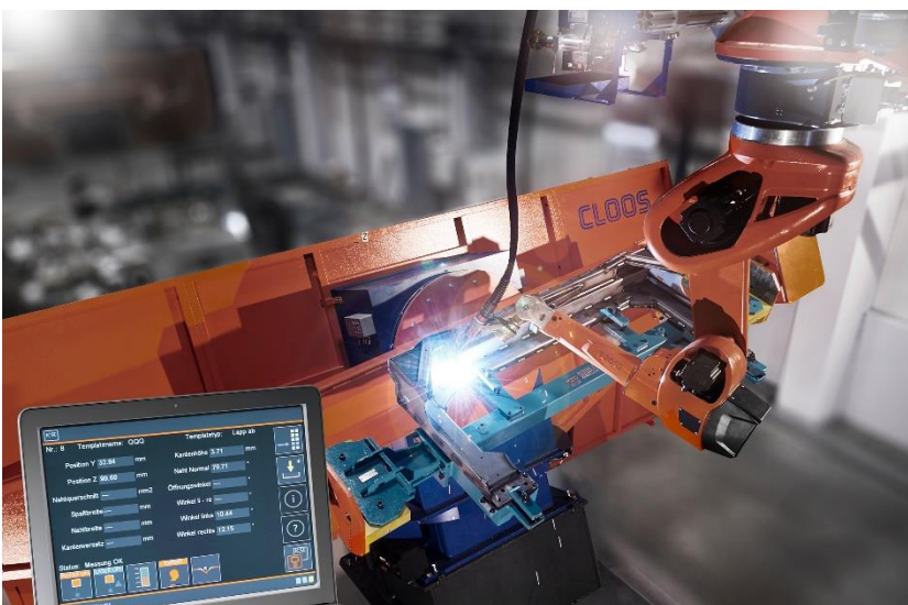
Bild 2 und 3: Die C-Gate IoT Plattform bietet ein umfassendes Monitoring von QIROX-Roboteranlagen und QINEO-Schweißgeräten.
