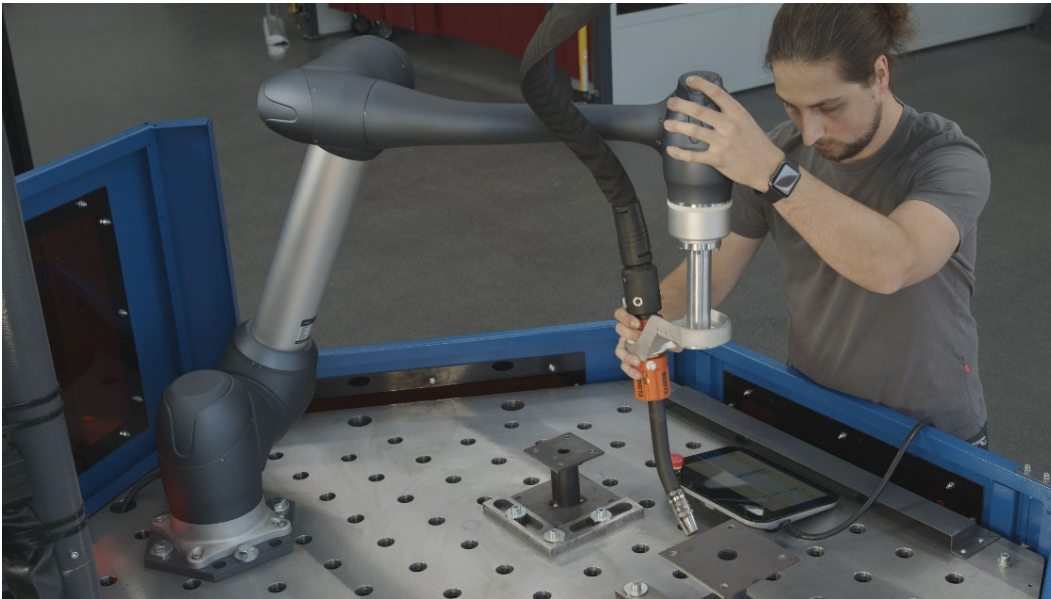
Bild 1: Das neue Cobot Welding System bietet einen einfachen Einstieg in das automatisierte Schweißen.
