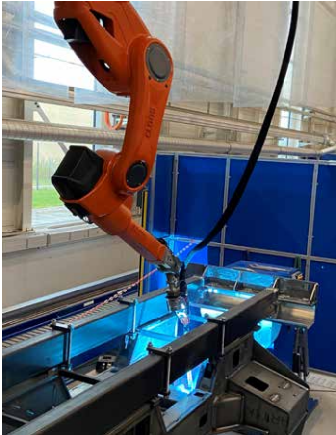
Bild 3: Der 7-achsige QIROX-Schweißroboter QRC-350-E ist über Kopf an einem Vertikalhub montiert.
